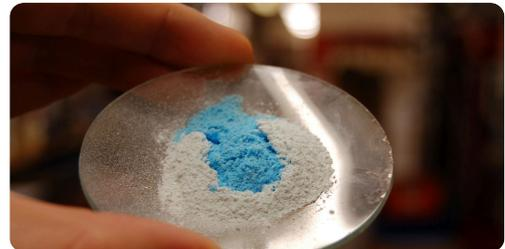
Das wasserfreie (weiße) Kupfersulfat wird mit einigen Tropfen Wasser versetzt: es wird dabei blau. Es entsteht Kupfersulfat-Hydrat. Durch Erhitzen kann das Wasser wieder entfernt werden.
