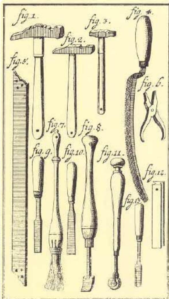
1 Rückenrunde-Hammer – 2 Hammer zum Ableimen – 3 Hämmerlein zum Klausurenanschlagen – 4 Goldschnittraspel – 5 Eisenlineal – 6 Biegezange – 7 Kleisterpinsel – 8 Glättekolben – 9 Stechbeitel – 10 Stemmeisen – 11 Gravierte Rolle für gepunzte Goldschnitte – 12 Einreibehölzchen für Bünde (Vorläufer der Bündezange) – 13 Eckenabstosseisen.
