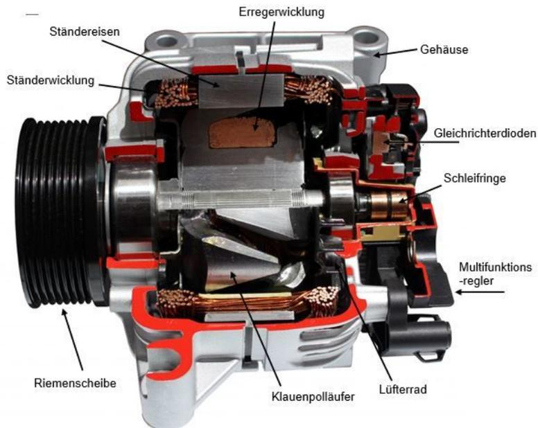
Schnitt durch einen **Kompakt-generator** mit Klauenpollläufer.
