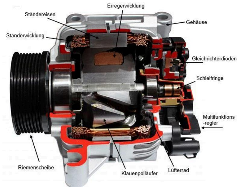
Schnitt durch einen **Kompakt-generator** mit Klauenpollläufer.
