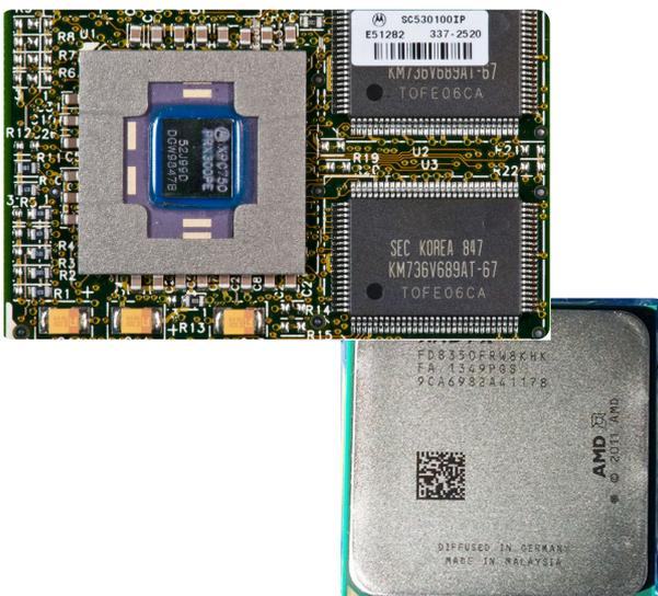
Der Prozessor oder auch CPU (Central Processing Unit) genannt, ist der Ort des Computers in dem alle Rechenoperationen vorgenommen werden. Man könnte auch sagen, dass es das Gehirn des Computers ist. Die CPU steuert die anderen Bestandteile eines Computers und führt
