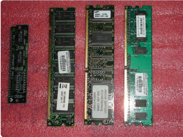
Der Arbeitsspeicher wird auch als RAM (Random Access Memory) bezeichnet. Er ist das Kurzzeitgedächtnis eines Computers. Alle Dateien (Textdateien, Bilder, Videos, usw.) die nicht auf der Festplatte gespeichert sind, werden auf dem Arbeitsspeicher kurz abgelegt. Wenn der Computer ausgeschaltet wird, dann ist der RAM automatisch leer und er hat diese Dateien wieder "vergessen" oder verloren.
