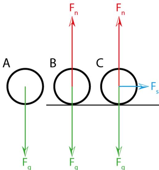
A: Nur die Gravitationskraft wirkt und beschleunigt die Kugel. B: Eine Tischplatte übt eine Gegenkraft auf die Kugel aus. Gravitationskraft und Gegenkraft sind gleich groß aber entgegengesetzt, sie heben sich auf, die Kugel bleibt in Ruhe. C: zusätzlich wird an der Kugel gezogen, die Kugel beschleunigt zur Seite.
