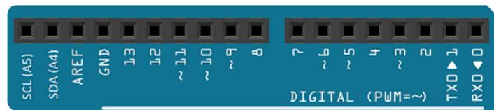
Der Arduino UNO besitzt 14 digitale, das heißt entweder 0 Volt oder +5 Volt, Ein- bzw. Ausgänge. Die Pins sind von 0 bis 13 nummeriert. Pin GND - Ground bzw. Masse.
