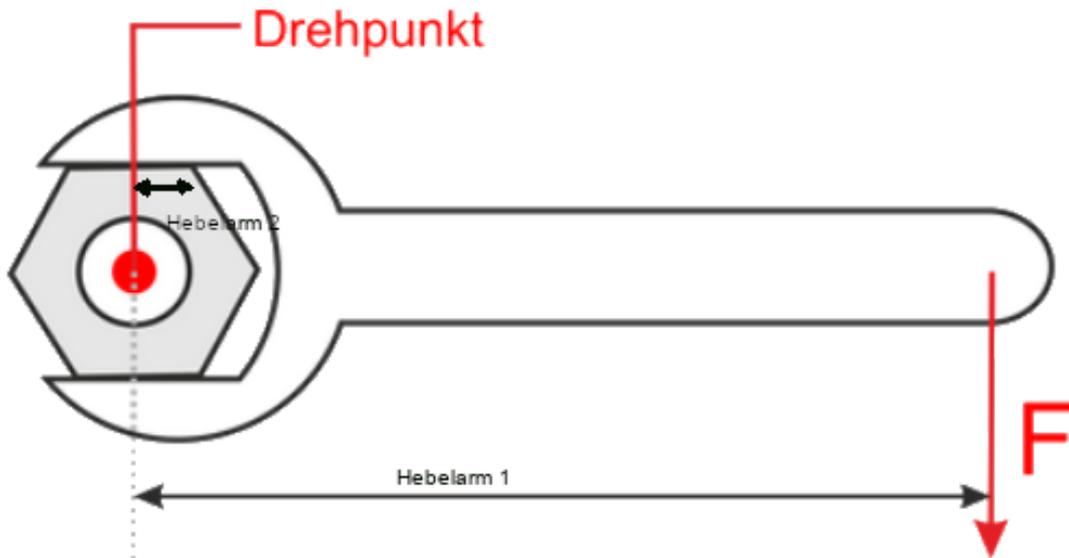
Beispiel eines Hebels: Schraubenschlüssel
