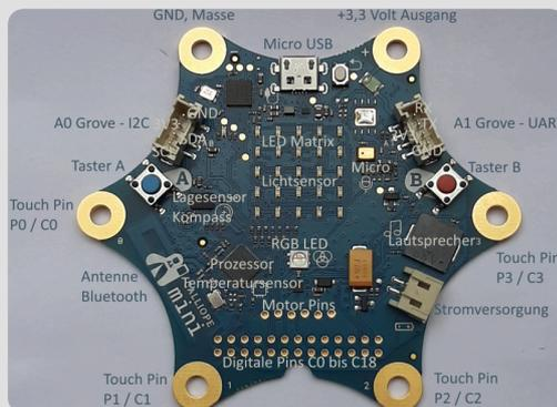
Der Calliope mini hat on-board schon einen **Lagesensor, Kompass, Beschleunigungssensor, Mikrofon, Lichtsensor, Lautsprecher, RGB-LED, eine LED-Matrix** und **2 Taster** welche direkt verwendet werden können.
