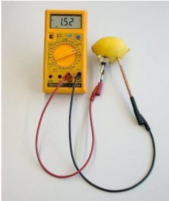
Abb.3: Zitronenbatterie (entnommen von: https://www.chemieunterricht.dedc2grundschversucheg-s-v-005.htm )
