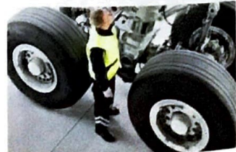
5 Mit Stickstoff befüllte Reifen
