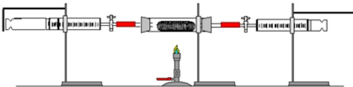
Versuch: Verbrennung von Eisenwolle mit 100 ml Luft
