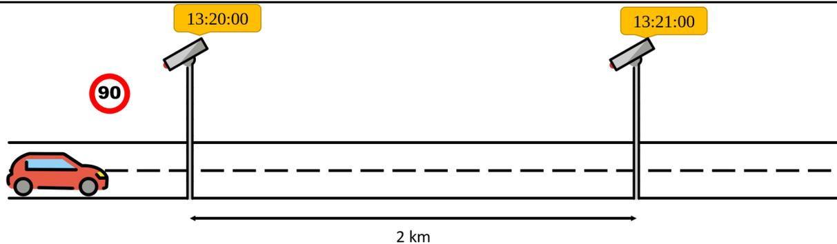
Zur Geschwindigkeitskontrolle werden teilweise so genannte Abschnittskontrollen durchgeführt. Dabei wird an zwei Punkten einer Strecke die Zeit gemessen, zu der ein Fahrzeug diesen Punkt passiert.
