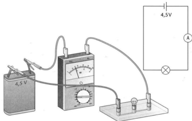
Abb. 1: Messung der elektrischen Stromstärke
