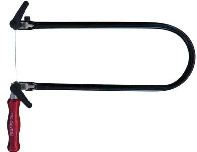
Mit der **Laubsäge** lassen sich feine Sägearbeiten an Sperrholz erledigen. Sie arbeitet auf Zug. Das heißt, die Zähne zeigen nach unten.
