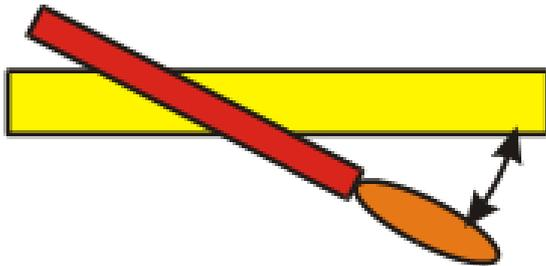
Bei schmalen Werkstücken muss der **Winkel** zwischen der Feile und dem Werkstück **klein** sein.
