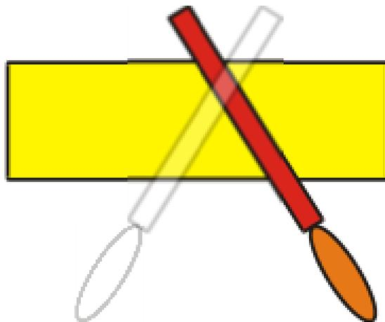
**Beim Vorfeilen größerer Flächen** wird die Schruppfeile **kreuzweise über die Werkstückfläche** geführt.
