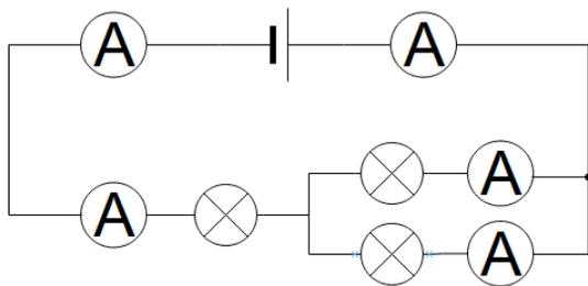
Abb. 4 — Kombinierte Reihen- und Parallelschaltung dreier Lampen
