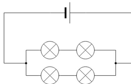
Abb. 5 — Vier Lampen in kombinierter Reihen- und Parallelschaltung
