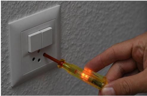
Phasenprüfer im Einsatz
