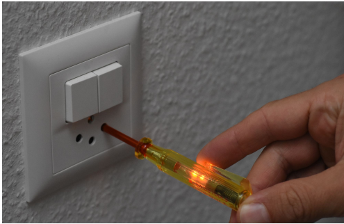
Phasenprüfer im Einsatz
