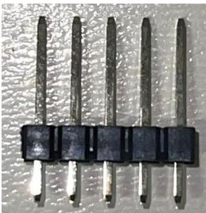
Schaue nach, ob alle **Pins** der **Steckerleisten** an allen Stellen an denen sie verlötet sind fest sitzen, durch verschiedene Belastungen können die Lötstellen, oder auch die Pins brechen.
