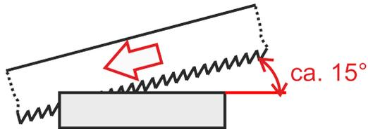
← Beim Ansetzen der Säge verwende einen **möglichst kleinen Ansetzwinkel**, damit die Zähne nicht ausbrechen. Säge **mit leichtem Druck**.
