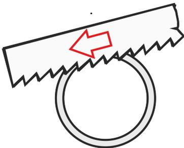
← **Rohre** werden beim Trennen **stückweise weitergedreht**, damit die Zähne nicht ausbrechen.
