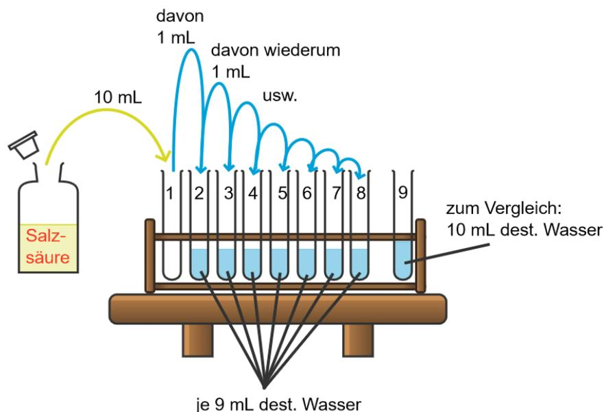
1. Überführe nun mit der Pipette genau 1 mL aus **Reagenzglas Nr. 1** in **Reagenzglas Nr. 2**
