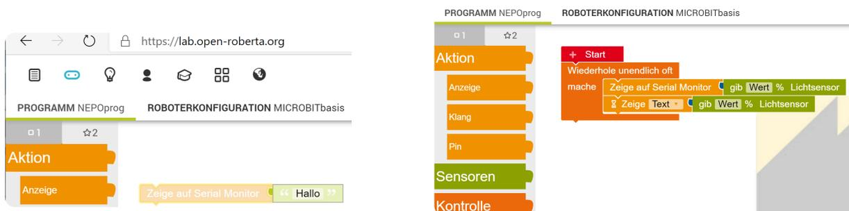
Das Programm auf den Micro:bit/Calliope laden. Im Verbindungsprogramm den Menüpunkt Serial Monitor auswählen. Die Baudrate für den Micro:bit und dem Calliope mini auf 115200 einstellen.
