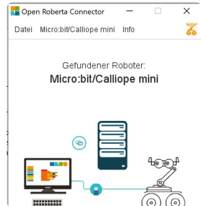
In OpenRoberta das System Micro:bit bzw. Calliope mini einstellen und Level 2 -> Aktion -> Anzeige -> Zeige auf serial Monitor auswählen. Programm erstellen in dem unendlich oft der Wert des Lichtsensors am serial Monitor und auch am 5x5 LCD-Block ausgegeben wird.
