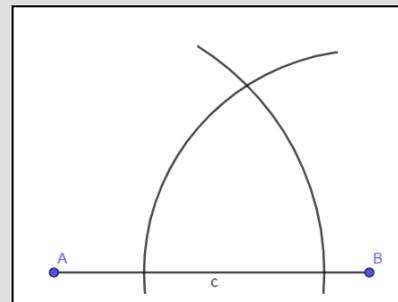
5. Der Schnittpunkt der beiden Halbkreise markiert den Punkt C. Verbinde ihn mit den Punkten A und B zu einem Dreieck.
