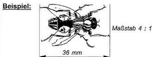
**Maßstab 4 : 1** bedeutet, dass die Fliege viermal so klein ist wie gezeichnet. Sie ist also nicht 36 mm lang, sondern nur 9 mm.
