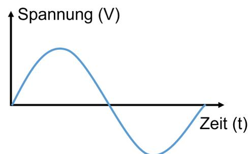
In unserem **Haushaltsnetz** fließt Wechselstrom mit einer Spannung von **230 Volt** und 50 Hz.
