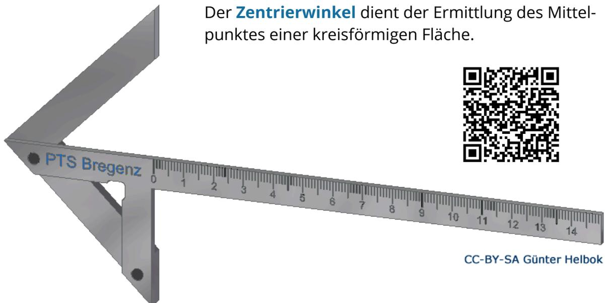
Der **Zentrierwinkel** dient der Ermittlung des Mittelpunktes einer kreisförmigen Fläche.
