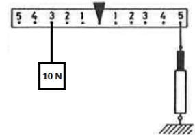
⑩ Welche Kraft zeigt der Kraftmesser im abgebildeten Versuch an? (D: Drehpunkt) / 1
