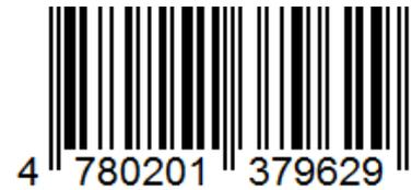
Ein solcher Barcode kann von entsprechenden Lesegeräten (zum Beispiel an der Kasse im Laden) eingescannt werden. Das Lesegerät berechnet aus jeweils zwei Linien und zwei Freiräumen eine Ziffer. Damit wir die so kodierte Zahl auch lesen können, ist sie nochmal darunter gedruckt. Der Scanner gibt bei Erfolg einen Piepton von sich und sendet die gelesene Zahl an den angeschlossenen Computer.
